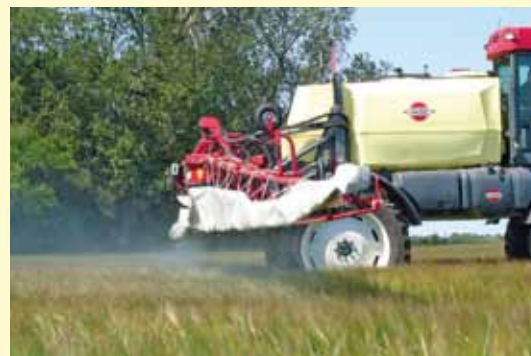
Op de bovenstaande foto's staat de TWIN met en zonder luchtondersteuning afgebeeld bij ca. 8-10 m/s tegenwind.
