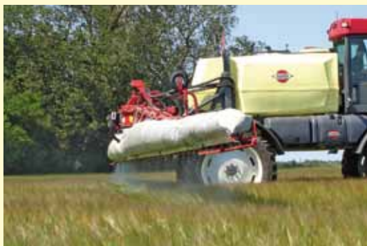
Op de bovenstaande foto's staat de TWIN met en zonder luchtondersteuning afgebeeld bij ca. 8-10 m/s tegenwind.
