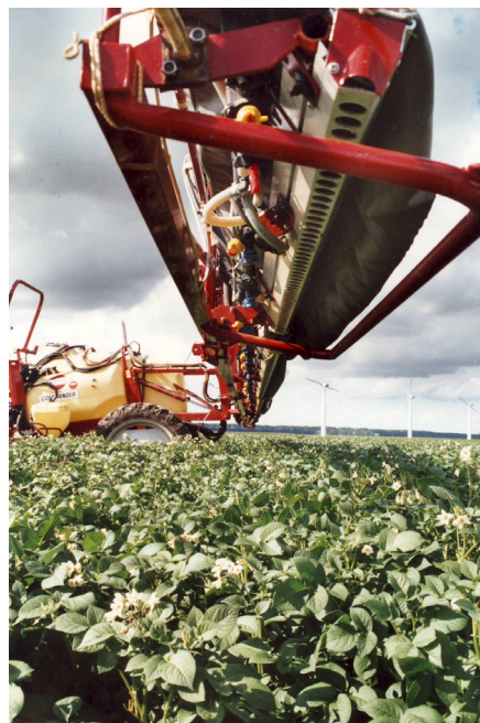
Onderaanzicht spuitboom met uitstroomopeningen luchtondersteuning.
