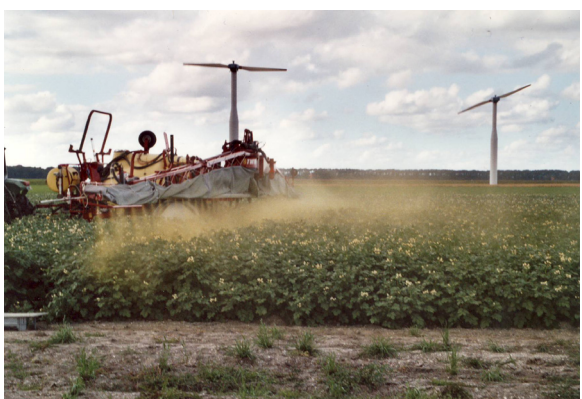
Driftmetingen met de Hardi Twin Force luchtondersteunde spuit: links zonder luchtondersteuning, rechts met luchtondersteuning.
