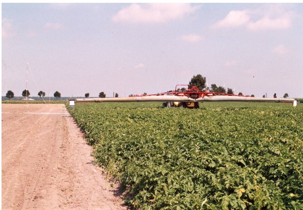
Driftmeting in aardappelen met luchtondersteuning.
