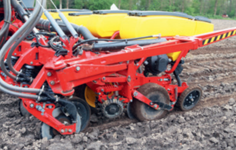
Het zaaielement voor voorliggende kunstmestkouters (let op de dubbele slangen), kluitenruimers, slepend opgehangen dieptewielen en geprofileerde naloopwielen.
