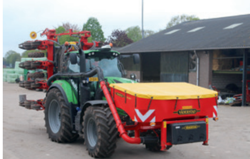
De fronttank wordt populairder vanwege een gunstiger gewichtsverdeling. Er past 2.200 liter in. Een inhoud die volgens Väderstad past bij hoge giften en hoge rijnsnelheden (250 kg/ha bij 15 km/h).
