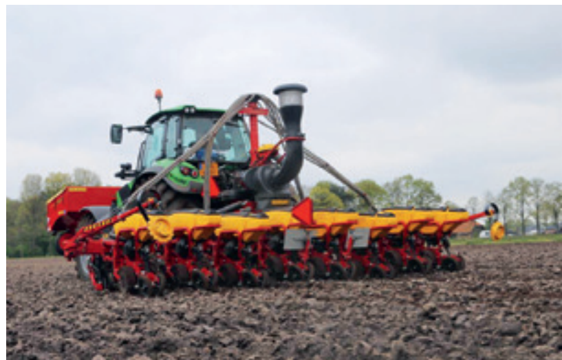
Een populaire optie is de verhoogde luchtaanzuiging zodat in droge omstandigheden minder stof wordt aangezogen.
