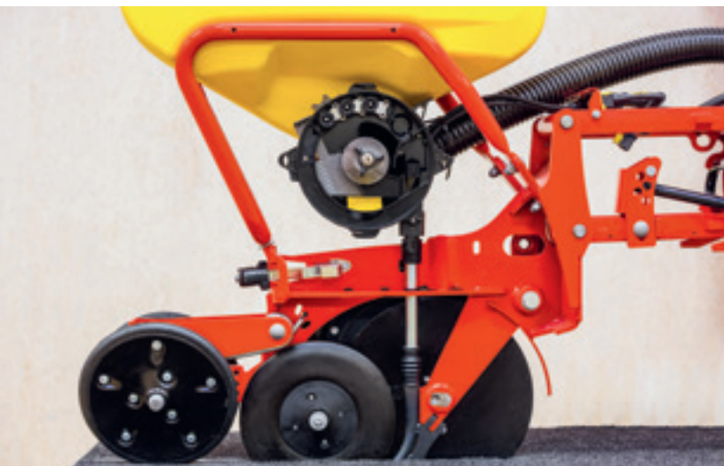
Een opengewerkt zaaihuis met bovenin de drie zwarte wieltjes die fungeren als roterende verenkelaars.
