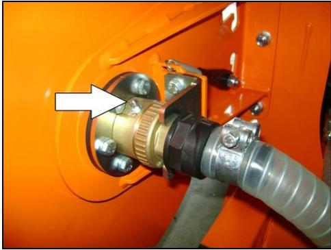
**61A. Graisseur joint tournant dévidoir du tuyau d'aspiration**
