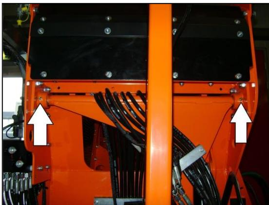
**61N. Graisseurs cylindres et pivots 3**
