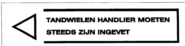
44 STICKER "TANDWIELEN HANDLIER MOETEN STEEDS ZIJN INGEVET"
