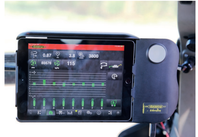
Op de tablet kan de chauffeur in een oogopslag zien welke elementen actief zijn en de balkjes geven aan hoeveel missers en dubbelen er zijn.
