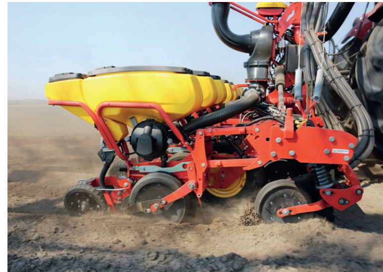
Het kunstmestkouter, uiterst rechts, wordt met veerdruk op diepte gehouden. Het zaaikouter in dit geval hydraulisch. De cilinder zit in het parallellogram.
