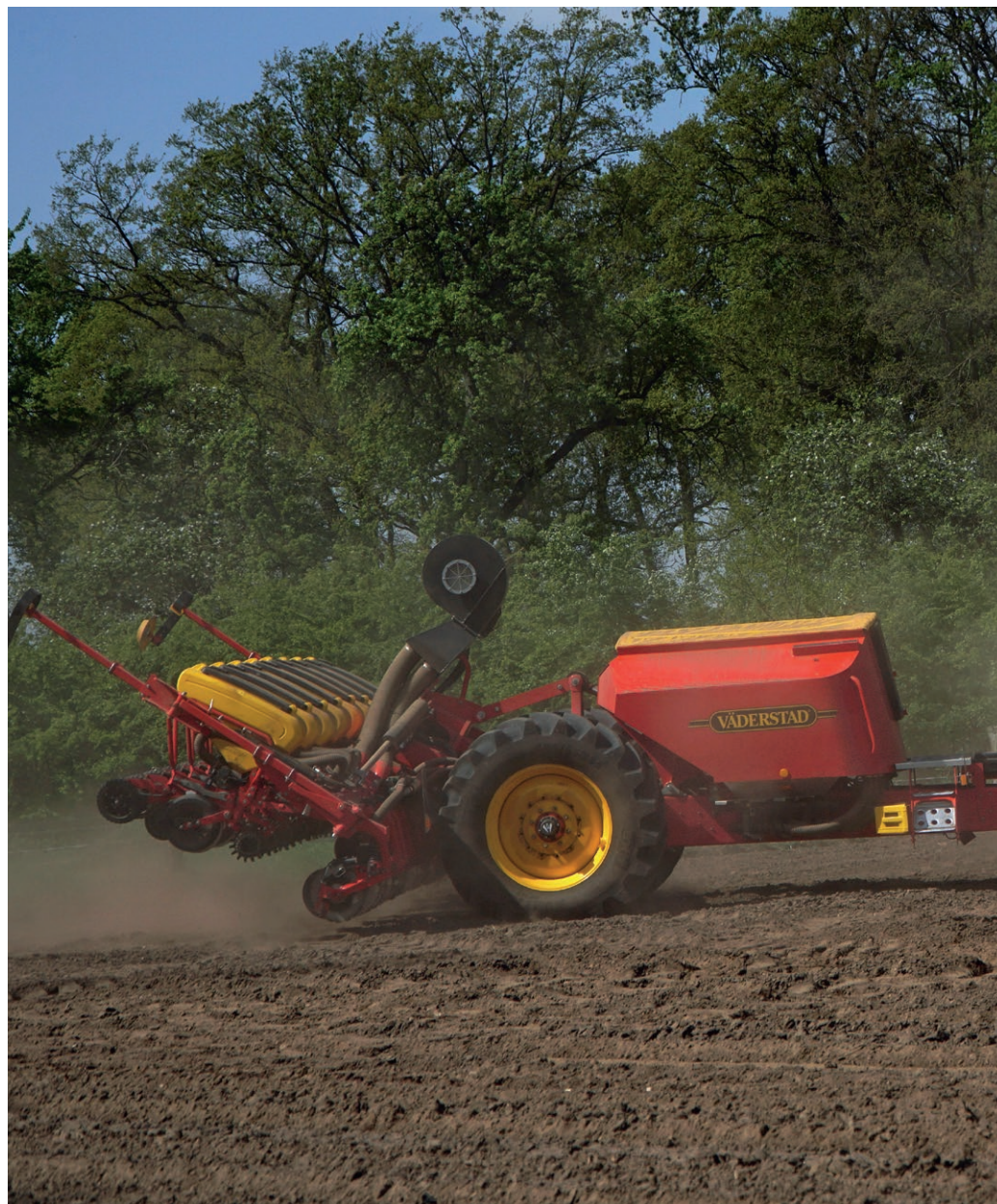
Op de kopakker zwenkt het frame met de elementen naar boven. Door het zwenken van het frame kun je ook meer of minder druk zetten op de elementen.
