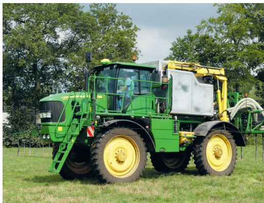
De zaaimachine is opgebouwd op een zelfrijdende spuit van John Deere met voldoende bodemvrijheid.
