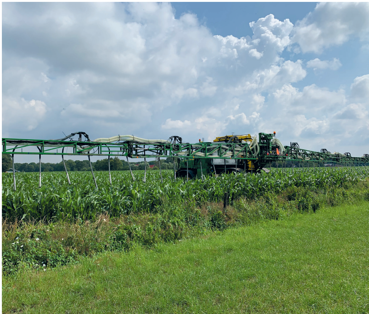
De machine heeft een werkbreedte van 36 meter. De zaaisnelheid ligt rond de 10 kilometer per uur.
