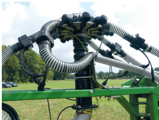
De verdeelkoppen hebben zes uitlopen met BlackEye-sensoren van Digitroll.
