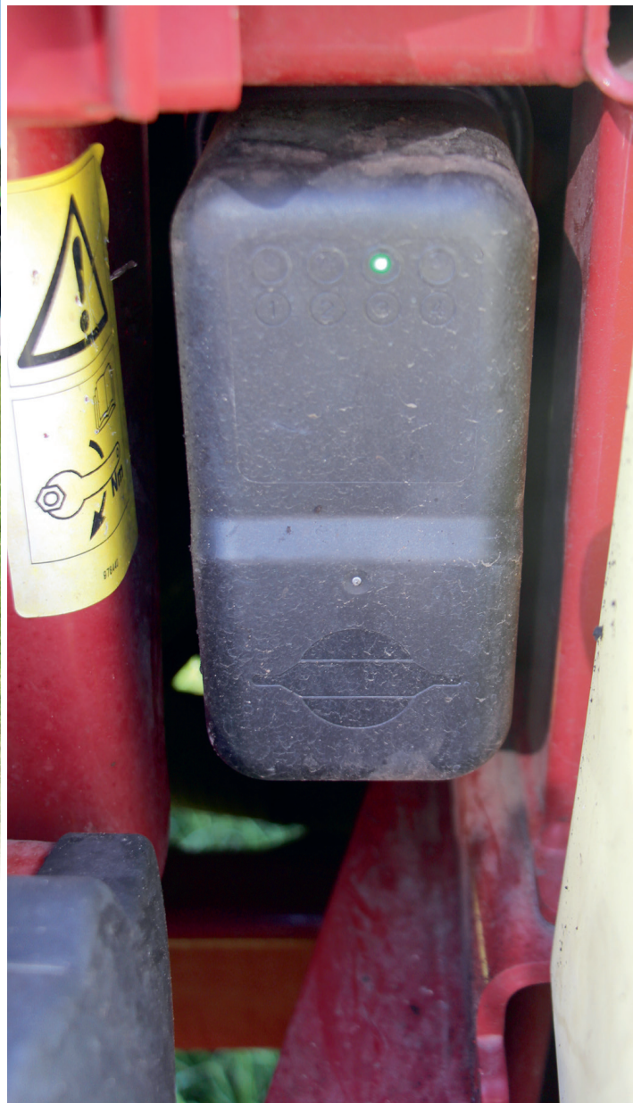
DynamicFluid4 meet met vier sensoren het pomptoerental, de positie van de kranen, de flow en de druk. Dit moet resulteren in een constante spuitdruk en afgifte.
