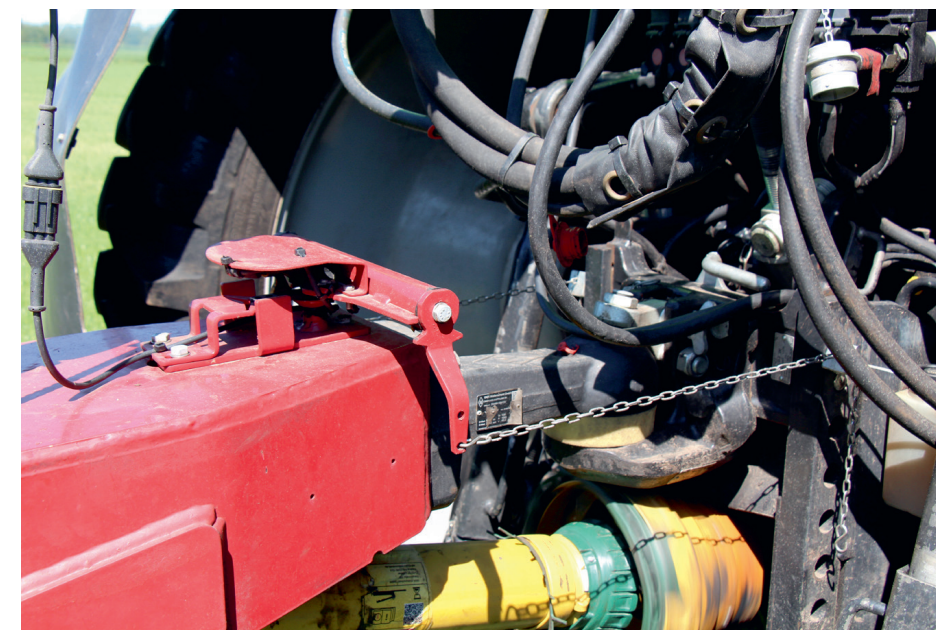
Via twee kettinkjes weet de elektronica continu de hoek tussen de trekker en de dissel.
