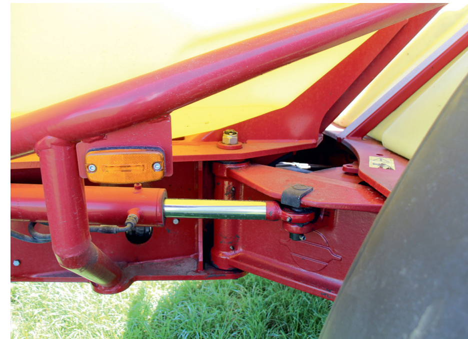
SafeTrack besturing op de Commander met links het hoofdframe met daarboven de hoofdtank en rechts de as met daarboven de schoonwatertank.
