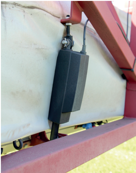
Enkele actuators kantelen de luchtzak en de spuitleiding naar voren (stekend) en naar achteren (slepend) naargelang de omstandigheden.
