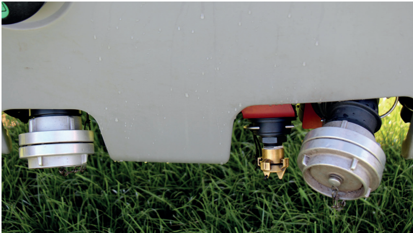
Rechts de aansluiting voor de vulslang en voor het vullen van de schoonwatertank. Links een aansluiting om overgebleven vloeibare kunstmest uit de hoofdtank te pompen.
