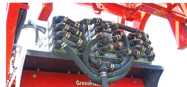
Bij MagGrow wordt de spuitvloeistof aan magnetische velden blootgesteld. De MagGrow-techniek in combinatie met een verlaagde spuitboomhoogte van 40 cm verhoogt de driftreductie met één klasse.
