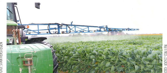
Het verlagen van de spuitboomhoogte van 50 naar 30 cm, gecombineerd met 80 of 90 graden tophoekdoppen met dopafstand 25 cm, verhoogt de driftreductie met twee klassen.
