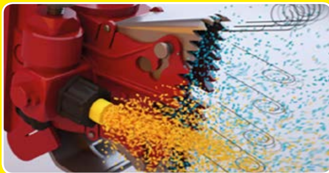
Roterende schacht voor individuele sluiting of aanpassing van de luchtstroom.
