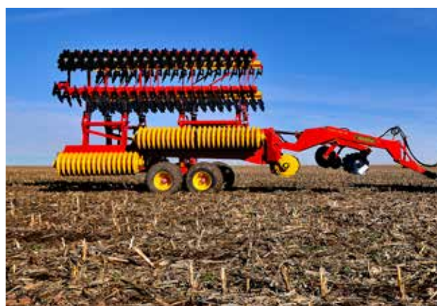
De Carrier XL 925-1225 is uitgerust met het unieke in- en uitklapsysteem van Väderstad. In ingeklapte toestand is de transportbreedte 3 m.
